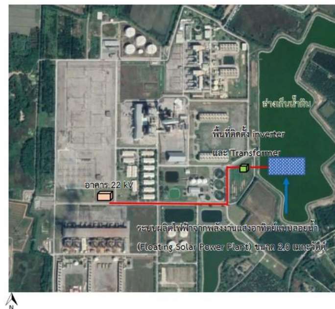
รูปที่ 1.3-3 แบบแปลนแสดงตำแหน่งติดตั้งระบบผลิตไฟฟ้าจากพลังงานแสงอาทิตย์แบบลอยน้ำ บริเวณพื้นที่อ่างเก็บน้ำดิบภายในโรงไฟฟ้าฯ
